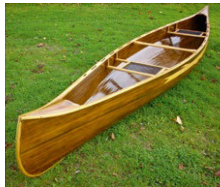
» Eine Schicht aus Glasfaser und Epoxidharz sorgt für langen Fahrspaß.
